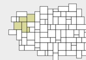
**NOTA BENE:** Si raccomanda di vibrocompattare la pavimentazione a fine posa con battitrice leggera e con piastra protetta da tappetino in PVC.
